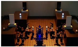
Aufnahmen aus dem Quantenoptiklabor in Erlangen. Auf der linken Seite befindet sich die Messstation "Alice" auf der rechten die Messstation "Bob", jeweils mit den beiden Möglichkeiten Schwarz und Weiß. Die Lämpchen geben an, welche der vier Kombinationen für diese Messung von Omega realisiert wurde.
